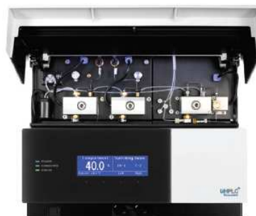
Фигура 5. Модулите RSLCnano с водеща в индустрията производителност за ултра-BETX nano/cap приложения. Dionex™ NCS-3500RS на Thermo Scientific™ интегрира nano/cap помпа, трикомпонентната LPG микропомпа и отделение за загряване на колоните в един корпус.
