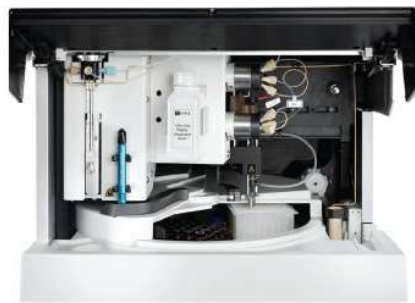
Фигура 20. Полу-препаративният аутосемплер UltiMate 3000 обезпечава широк диапазон от инжекции до 2.5 mL.
