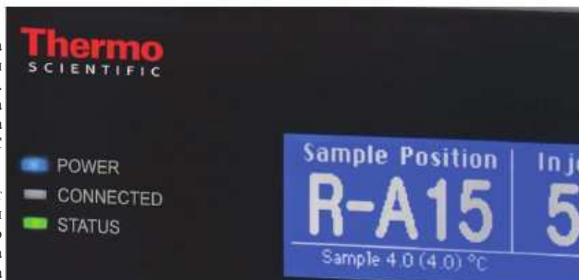
Фигура 7: Термостатирането на пробите до 4°C осигурява тяхната стабилност.
