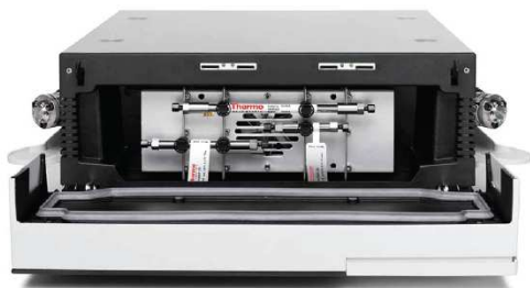
Фигура 1. Колонният термостат за бързо разделяне (RS) Ultimate 3000 и стандартният колонен термостат(SD) обезпечават място за до 12 колони, в зависимост от дължината на колоните.
